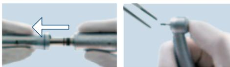
Retirer les instruments du raccord turbines MULTiflex ou moteur.
