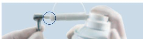
Nettoyer une fois par semaine la griffe de serrage des instruments et turbines. Utiliser pour ce faire le spray KaVo et l'embout d'entretien conique.
